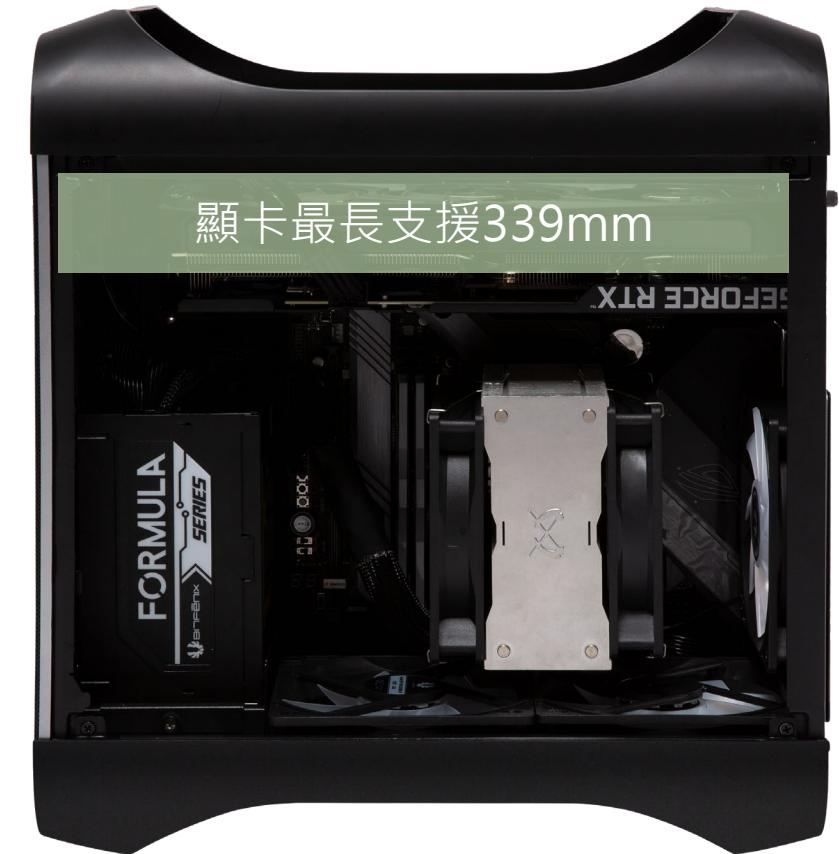
新一代 小巨蛋，在頂部或側面安裝，GPU 空間均為 339mm，可使用市場上最頂級的顯卡，
